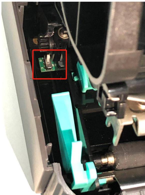
3. 根据标签纸类型进行对应的感应器校正
