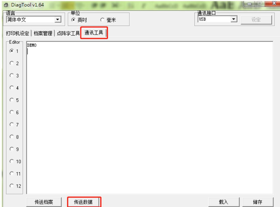
有变量时，输入档案名回车，再输入对应的变量数据回车，点击“传送数据”按钮即可打印对应模板
