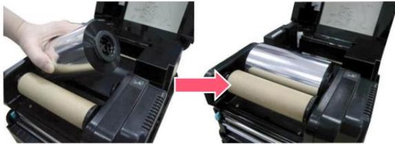
3. 依相同方法将碳带卷轴插入碳带轴中。并将其安装入碳带供应轴的位置。
